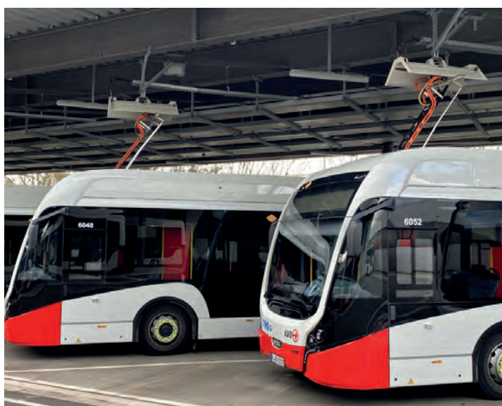
Aufladung von E-Bussen auf einem Betriebshof (hier KVB-Betriebshof in Köln-Riehl), Bild: Stephan Anemüller/KVB.
