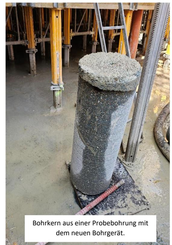
Bohrkern aus einer Probebohrung mit dem neuen Bohrgerät.
