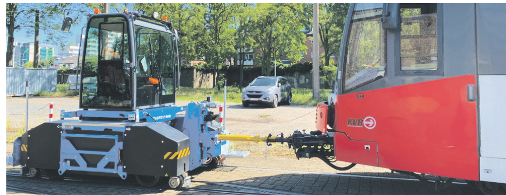
Das Rangiergerät kann auf der Schiene wie auf der Straße fahren
