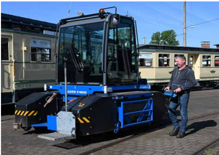
Flexibleres Arbeiten mit dem wendigen und vollelektrischen Rangiergerät.
