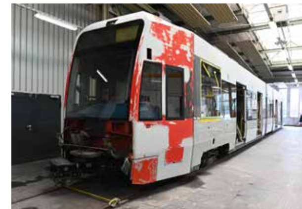
Nach einem Unfall werden die Schäden am Fahrzeug repariert, das Fahrzeug für die Lackierung vorbereitet und dann neuer, glänzender Lack aufgetragen
