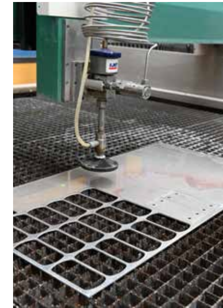
Wasser, das mit feinem Sand angereichert ist, schneidet mit hohem Druck durch das Metall
