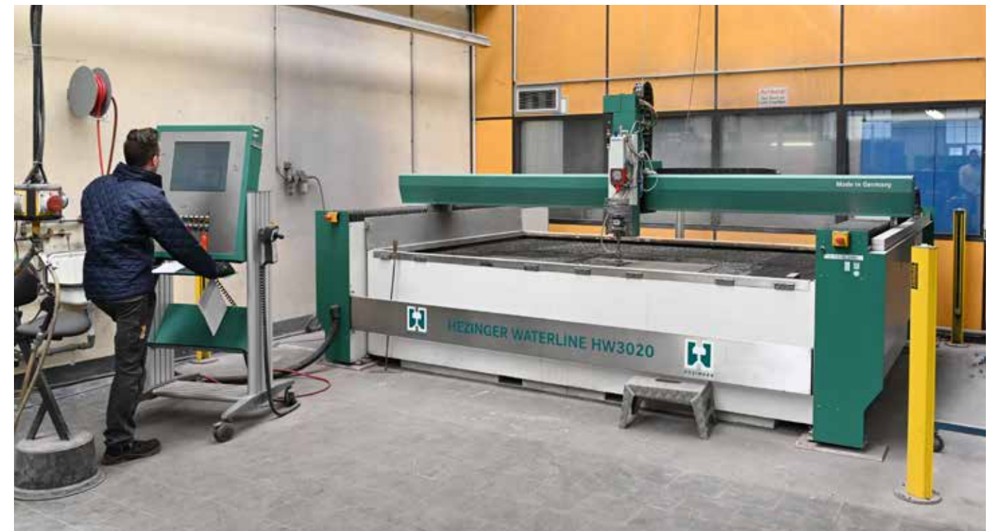
Als Alternative zum Ausstanzen hat sich der Wasserstrahlschneider bewährt
