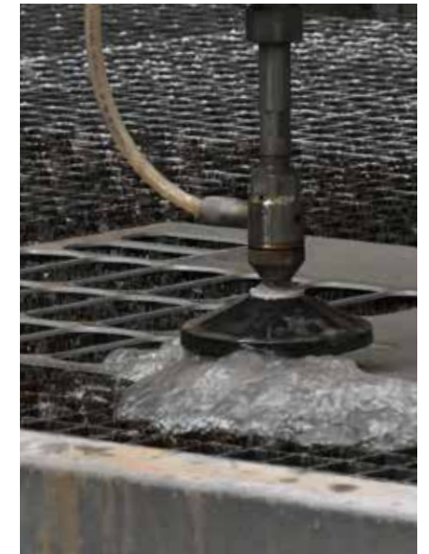
Bis zu 50 mm dicke Metallblöcke können mit dieser Technik durchgeschnitten werden
