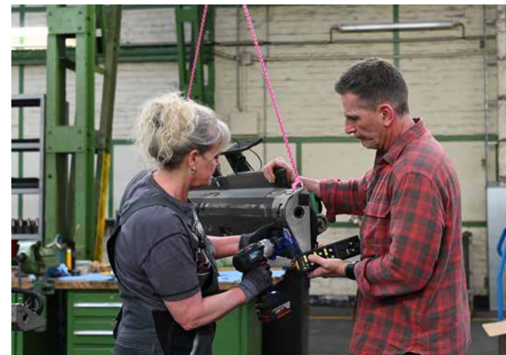
Häufig treten Störungen an den Türen auf, die an einem eigenen Arbeitsstand geprüft und repariert werden
