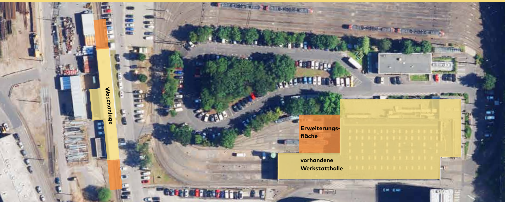
Der Betriebshof West: Das linke längliche Gebäude ist die Wasch- anlage. Damit dort zukünftig die längeren Züge gesäubert werden können, muss die Halle vergrößert werden. Das gilt auch für die Werk- statthalle, die rechts im Bild zu sehen ist.
