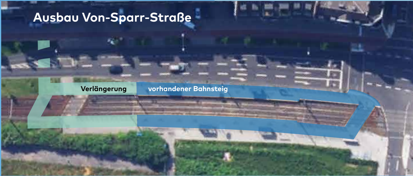
Beispiel eines Umbaus der Haltestelle Von-Sparr-Straße. Der Bestandsbahnsteig wird um zehn Meter verlängert. Alle angrenzenden Verkehrsflächen, z.B. die Gleisquerung oder der Fußgängerüberweg, müssen entsprechend ebenfalls um zehn Meter verschoben werden.
