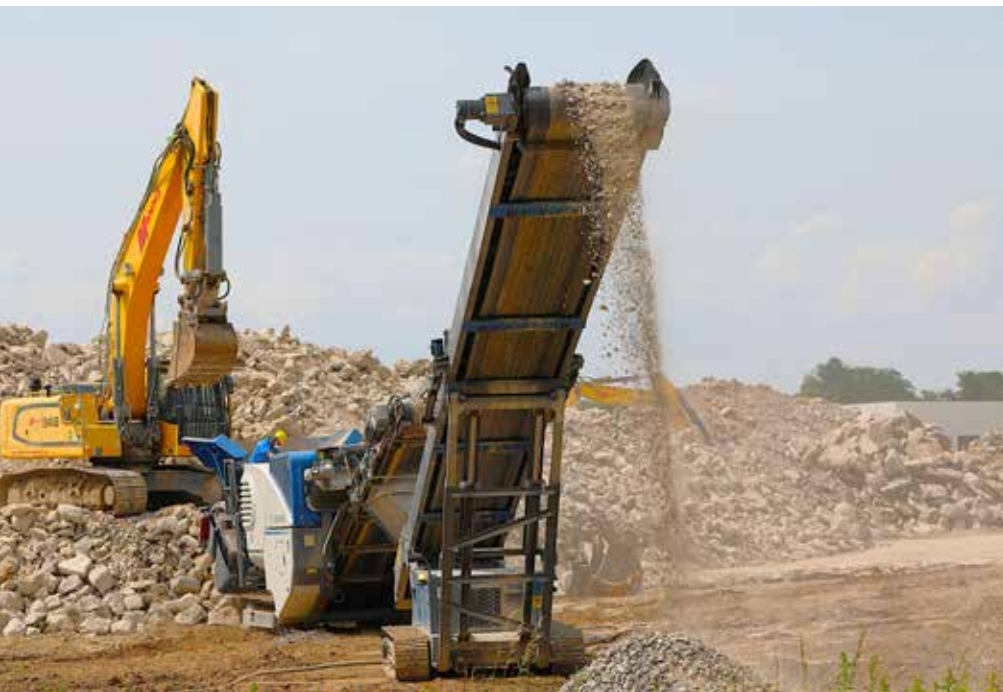
Mit der Brechmaschine werden umfangreiche Betonmassen zu neuem Füllmaterial zerkleinert
