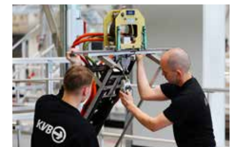
Wartung eines Pantografen
